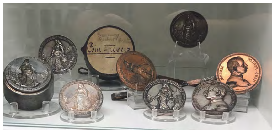
Die spannende Welt der Münzen: Mit dem Prägestempel links werden Medaillen aus Bronze geschlagen und mittels des Spannprätzens in der Mitte versilbert.
